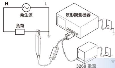
参照：「被測定回路への接続例」(p.47)
