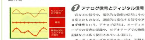
図2 アナログ信号と雑音 アナログ信号中に雑音が入ると、取り除くことがむずかしい。
