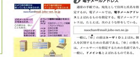
図1 メールアドレスの構造 電子メールアドレスの「@」の前はユーザID、後の部分は、メールサーバを指定する名前である。名前の部分は、右から、大きな範囲から小さな範囲を示すように、ドット(・)で区切られている。
